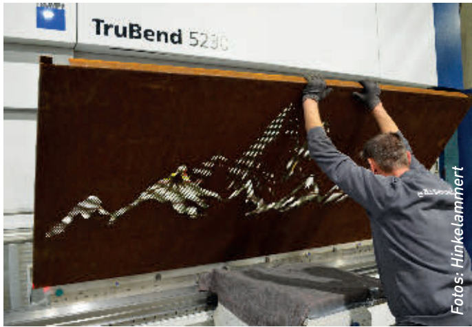
Lochraster- und Konturbilder: Das Ausschneiden individueller Motive erfolgt mittels Laserschneidverfahren.
